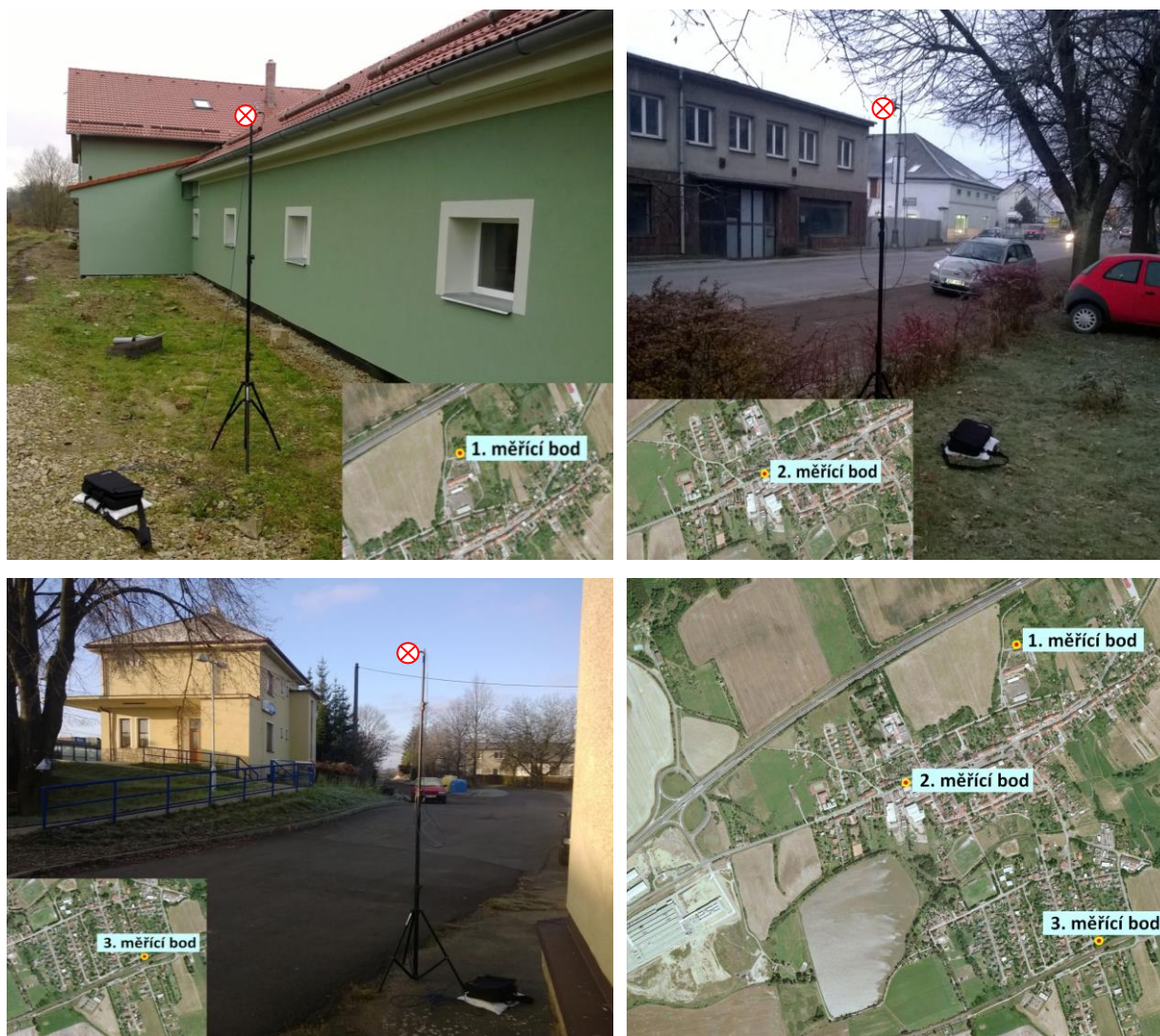
Obr. 11: Umístění mikrofonu zvukoměru během terénního měření [3]
